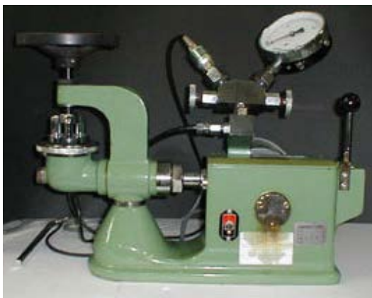
1. 破裂度計です。
