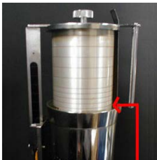
3. ドラムのロックを外すと、ゆっくり落ち始め、セットされた紙のほうへ空気が送りこまれます。
