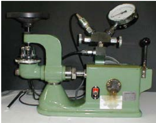
1. 破裂度計です。
