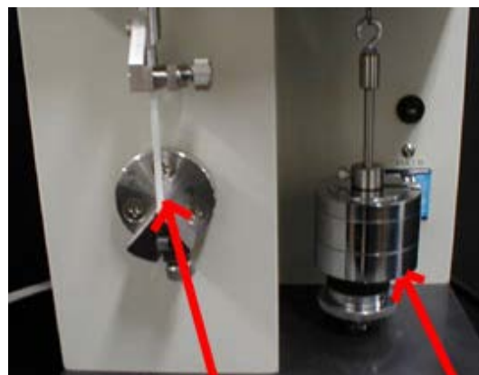
2. 左に紙をセットし、右の重りで荷重をかけます。
